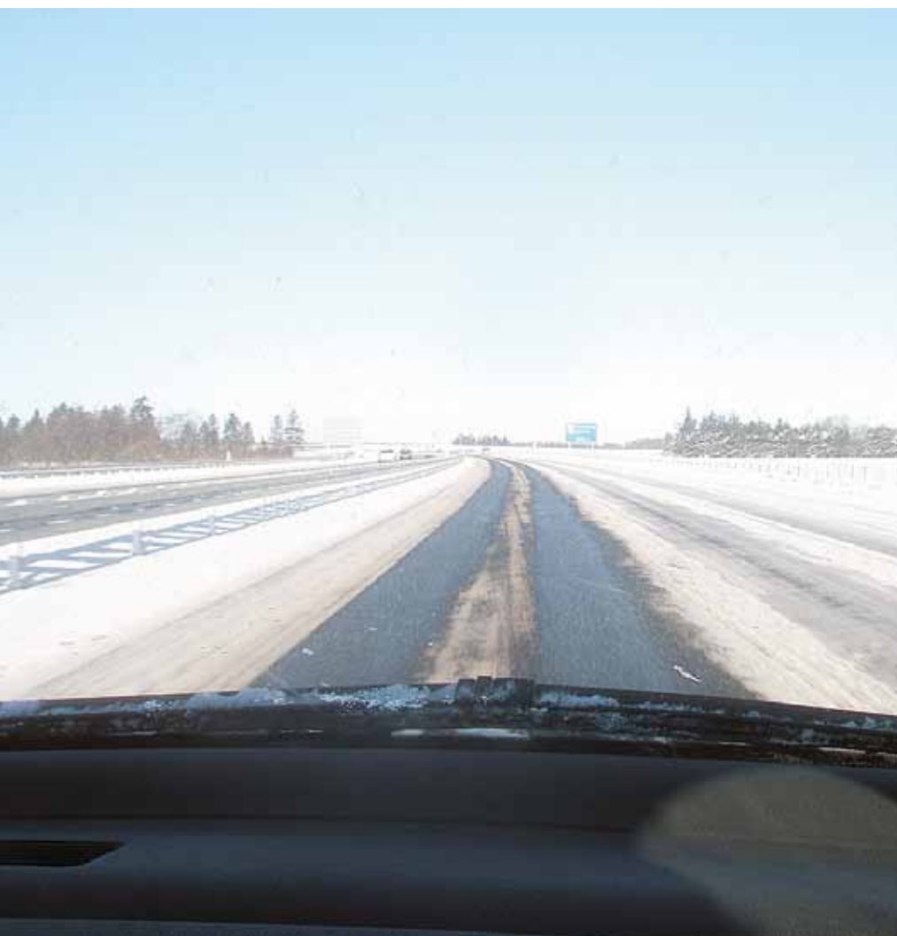
Figur 2. Snesituation der viser salt i overhalingsspor, men ikke i det tunge spor.
