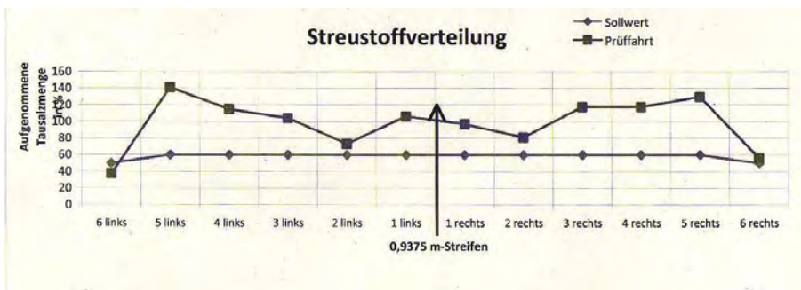
Figur 4. Salt spredning 11 m, hvide dyser bag lastbilen og stråle dyser til begge sider.
